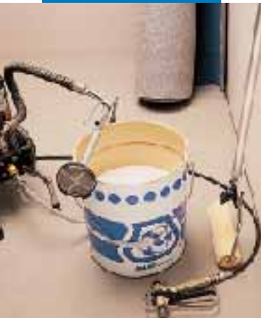
Pompa do natrysku i wałek do nanoszenia kleju Rollcoll
